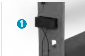
1 Приклейте контроллер на крепление
